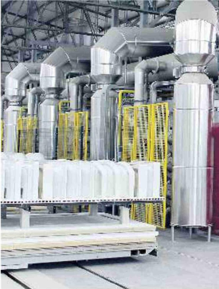
**ARREDO BAGNO** Un forno industriale a metano per la cottura dei pezzi in ceramica nel distretto viterbese
