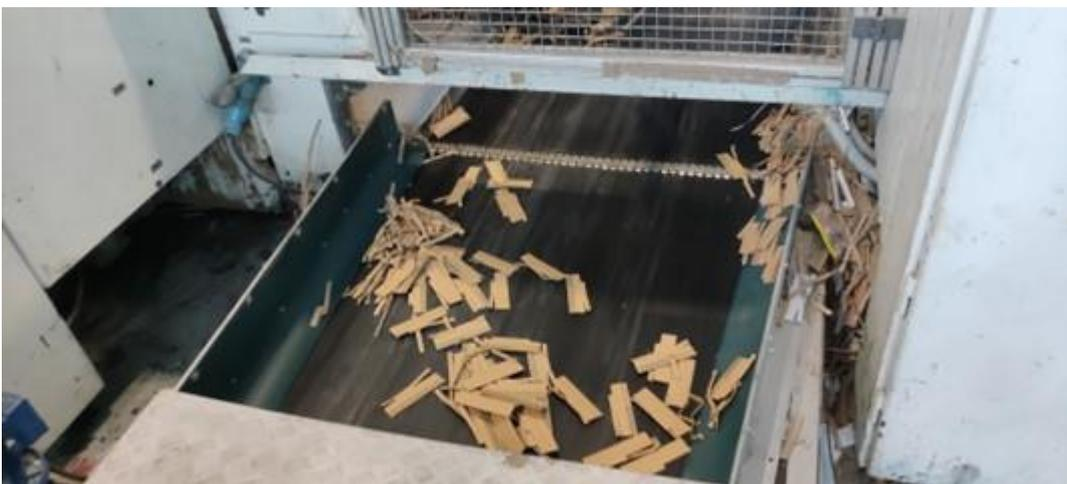
Figura 6 – Rifili di scarto prodotti dalle macchine di trasformazione costituiti da sfridi di cartone
