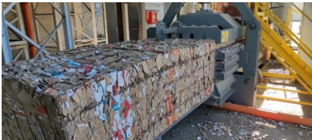
Figura 7 – Balle di rifili generate dalla pressa
