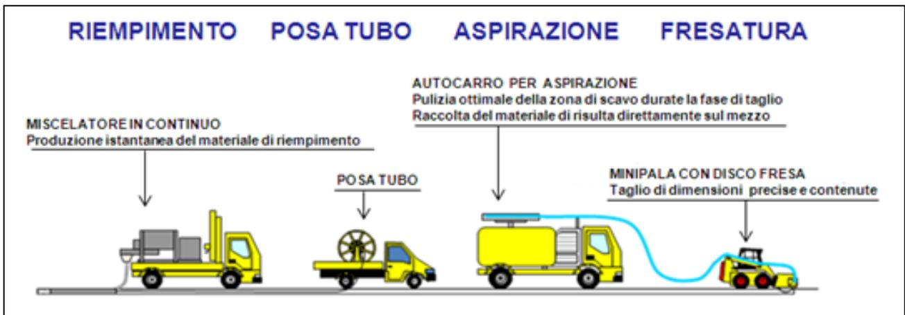
Figura 11 - Esempio di disposizione cantiere per minitrinca ridotta
