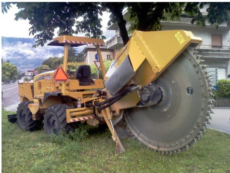
Figura 5 - Esempio di macchina di minitrincea
