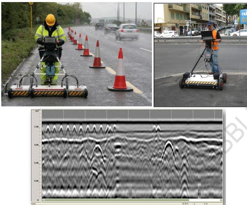
Figura 2 – Esempi di macchine radar e di generazione della mappa
