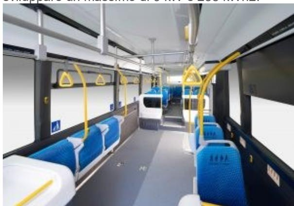
Il design di Sora differisce in parte dalla tipica forma a scatola degli autobus arricchendosi di un effetto stereoscopico che lo rende riconoscibile insieme alle luci a led anteriori e posteriori. La particolarità dell'interno è invece che i sedili vengono riposti automaticamente quando non vengono utilizzati, migliorando il comfort per i passeggeri, specie per quelli con passeggini o in sedie a rotelle.
