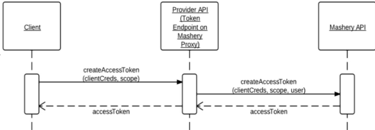
Figura 1 - Sequence Diagram per la generazione del Token
