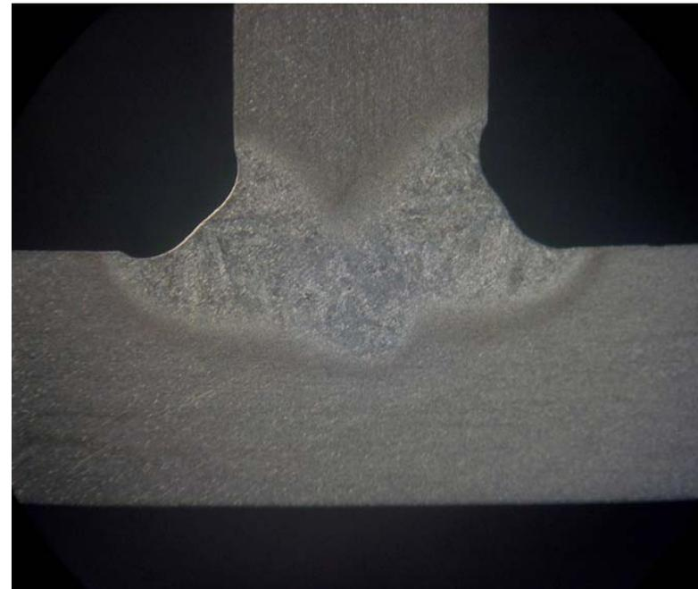
A sinistra l'aspetto superficiale che indica assenza di contaminazione atmosferica; a destra la sezione macrografica di un giunto realizzato con l'apparecchiatura sviluppata
