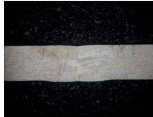
Saldatura di spessori sottili  $t=0,75\text{mm}$  Nitinol;  $P= 850\text{W}$ ;  $v= 2,4 \text{ m/min}$ ;
