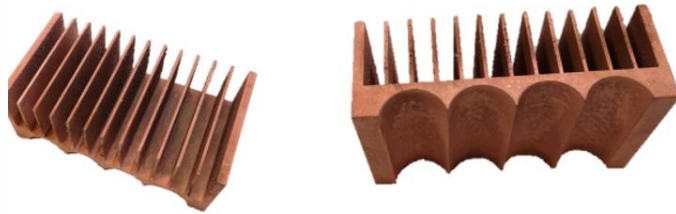
Dissipatori con trattamento di elettrodeposizione in Rame-Grafene
